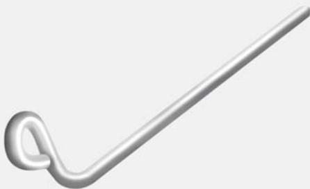
Abhängedraht mit Öse ist ein Metallelement aus feuerverzinktem Stahldraht mit Durchmesser 4 mm, an dessen Ende sich eine Öse befindet zur Befestigung an der Tragstruktur. Es wird für den direkten Gebrauch 90° abgewinkelt geliefert.
