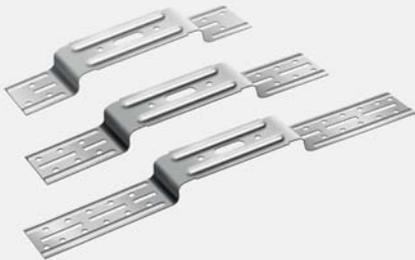
Justierschwingbügel ist ein Verankerungselement für Trockenbau, der durch Stanzen aus feuerverzinktem Stahlblech hergestellt wird. Er verfügt über Einprägungen für hohe Festigkeit und Öffnungen zur einfachen Befestigung an der Tragekonstruktion und dem CD-Profil.
