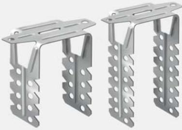
Direktabhänger CD ist ein Verankerungselement für Trockenbau, der durch Stanzen aus feuerverzinktem Stahlblech hergestellt wird. Er verfügt über Einprägungen für hohe Festigkeit und Öffnungen zur einfachen Befestigung an der Tragekonstruktion und dem CD-Profil.
