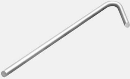
Abhängedraht mit Haken ist ein Metallaufhängeelement für Gipskartonkonstruktionen hergestellt durch Formen von feuerverzinktem Stahldraht mit einem Durchmesser 4mm. An einem Ende ist es mit einem Haken zur Befestigung an der Tragstruktur oder Deckenkonstruktion ausgestattet.
